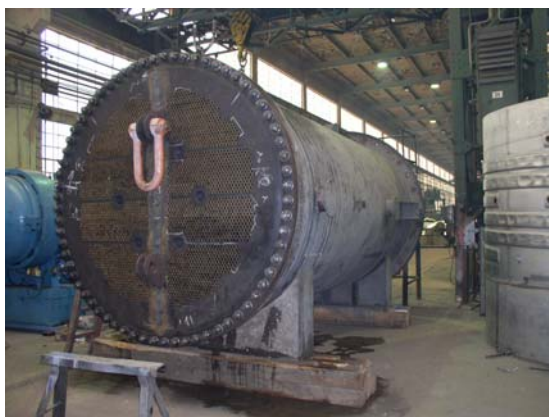
Obr. 5 Svazek výměníku s kondenzací
