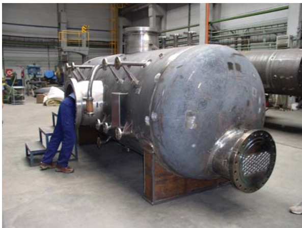
Obr. 4 Výměník / kotel s výrobou páry
