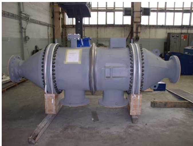
Obr. 7 Výměník s pevnými trubkovicemi a kompenzátorem v plášti
