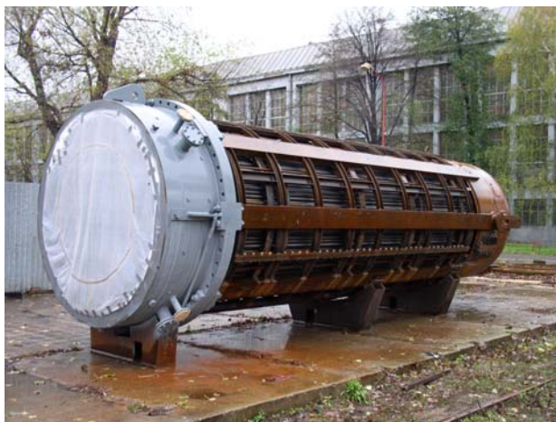
Obr. 10 Svazek vertikálního parního chladiče s plovoucí hlavou
