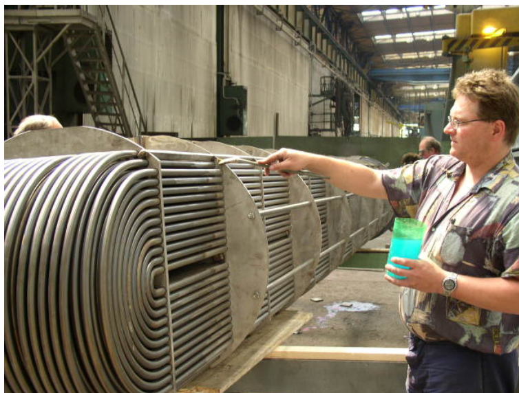
Obr. 12 Výměník s U – trubkami
