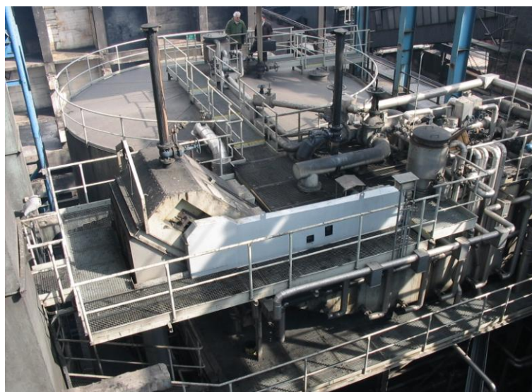
Рис. 3 Грубый отделитель дегтевых шламов, KB9, Коксовый завод Svoboda, Острава
