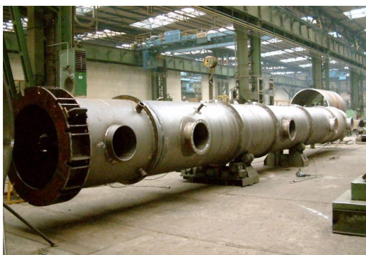
Рис.. 8 Изготовление колонны отгона бензола для фирмы Třinecké železářny, Тржинец
