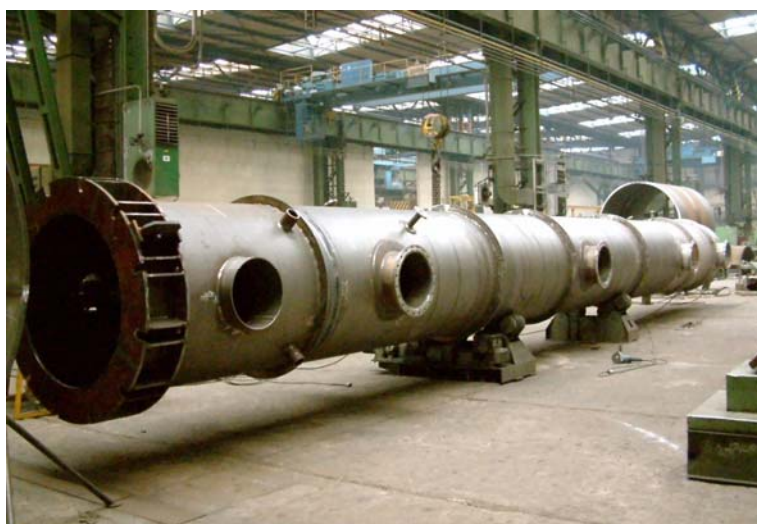
Fig. 8 Fabrication of Benzole Stripper for TŽ Třinec
