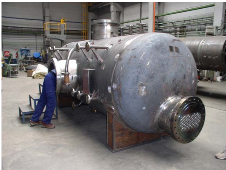
Obr. 7 Foto z výroby utilizačního kotle
